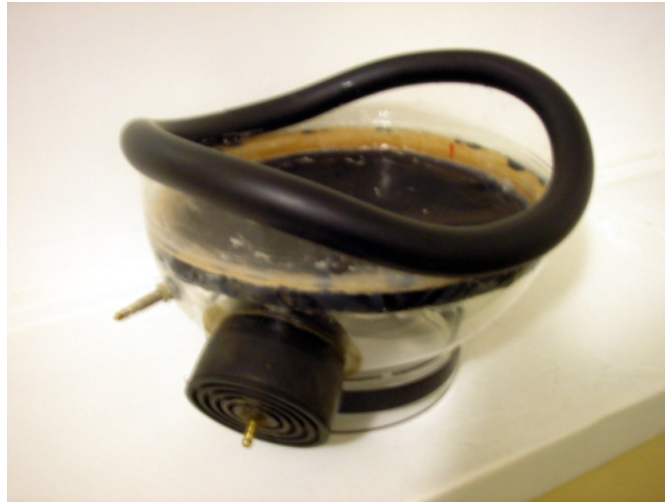
Figura 4.2: Fantoma utilizado para las pruebas de ABDOPRE.
