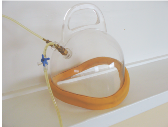
Figura 4.1: Campana de vacío con reborde de silicona vulcanizada.
