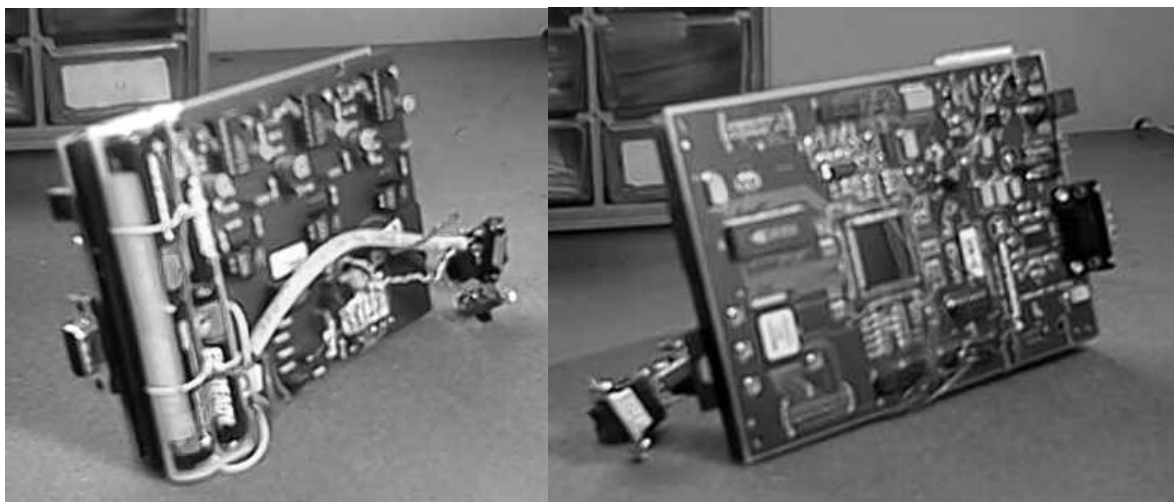
Figura 3.2 – Las dos placas de ADQCAR aún sin colocar en su caja: (Izq.: Vista de la placa que incluye los bloques Etapa de Entrada, MUX/ADC y memoria extraíble. Der.: Vista de la placa digital con el microcontrolador)
