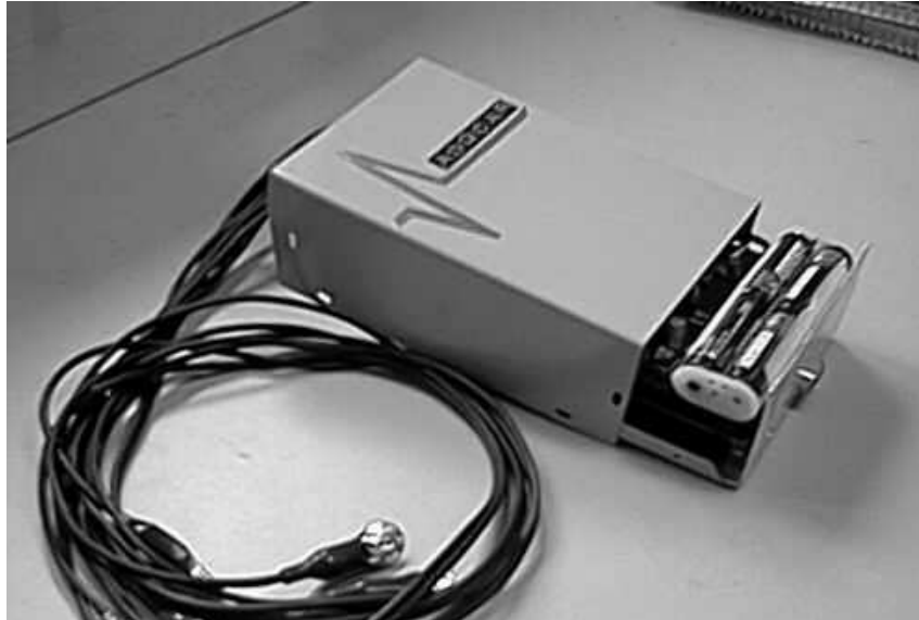
Figura 10.3 – Cubierta desplazada para el recambio de pilas.
