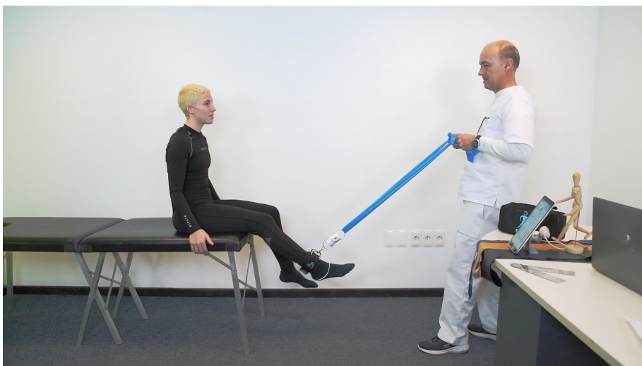
Figura 2.3: DINABANG en el consultorio de fisioterapia. Notar la cinta elástica, el sensor de fuerza y microprocesador (de color blanco) atado a la tobillera y a la cinta elástica, la unidad inercial colocada en la parte posterior de la tobillera y la tablet con la medida en tiempo real para realimentación del paciente que la mira. (MOVI, 2023)
