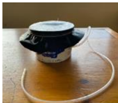
Fig. 2 Fantoma ABDOPRE simulando una presión de campana (Pc) negativa en su interior.
