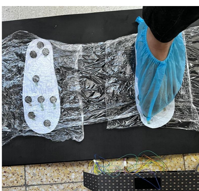
Fig. 2: Procedimiento de medida de presiones plantares con plantilla DIAPODAL. Protección papel renovada para cada paciente.
