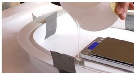
Fig. 3 Colada por gravedad de caucho siliconado en molde.
