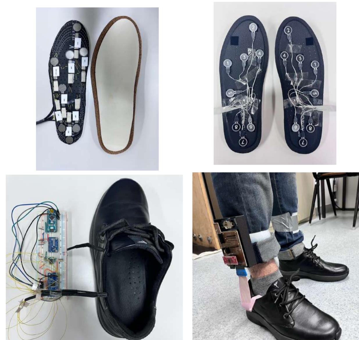
Fig. 3. Construcción de la primer versión de la plantilla DIAPODAL
