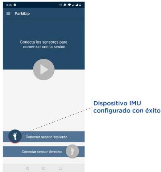
**Figura 1.7:** Conexión exitosa del IMU asociado al pie izquierdo -botón coloreado de azul-. PARKIBIP identifica al Pie/IMU con un color en la aplicación, en la imagen rojo. Es el mismo color que comienza a parpadear en el IMU mediante su luz LED.
