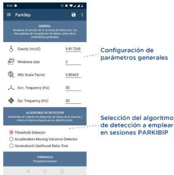
**Figura 1.13:** Configuración de parámetros y selección del algoritmo de detección. PARKIBIP habilita al usuario a modificar parámetros generales y específicos de los métodos.
