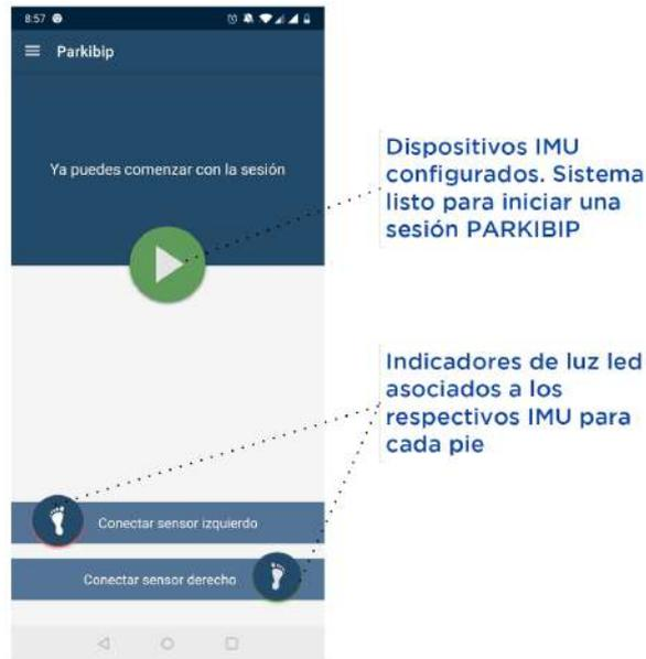
**Figura 1.8:** Configuración de los IMU exitosa. Ambos botones se encuentra en azul, las luces LED del IMU sincronizadas a los colores de los contornos de los botones, y el botón central es puesto en verde. PARKIBIP se encuentra listo para comenzar una sesión de rehabilitación.
