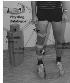
Figura 3. Un sujeto equipado con los sistemas inerciales en la cercanía de una referencia magnética [4]
