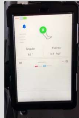
Fig.4 DINABANG informa fuerzas y ángulos articulares en dispositivo móvil asociado
