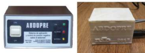
Fig 4. Gabinete de ABDOPRE en 2007 y 2017. El volumen se redujo de 2520 cm 3 a 378 cm 3 [4].
