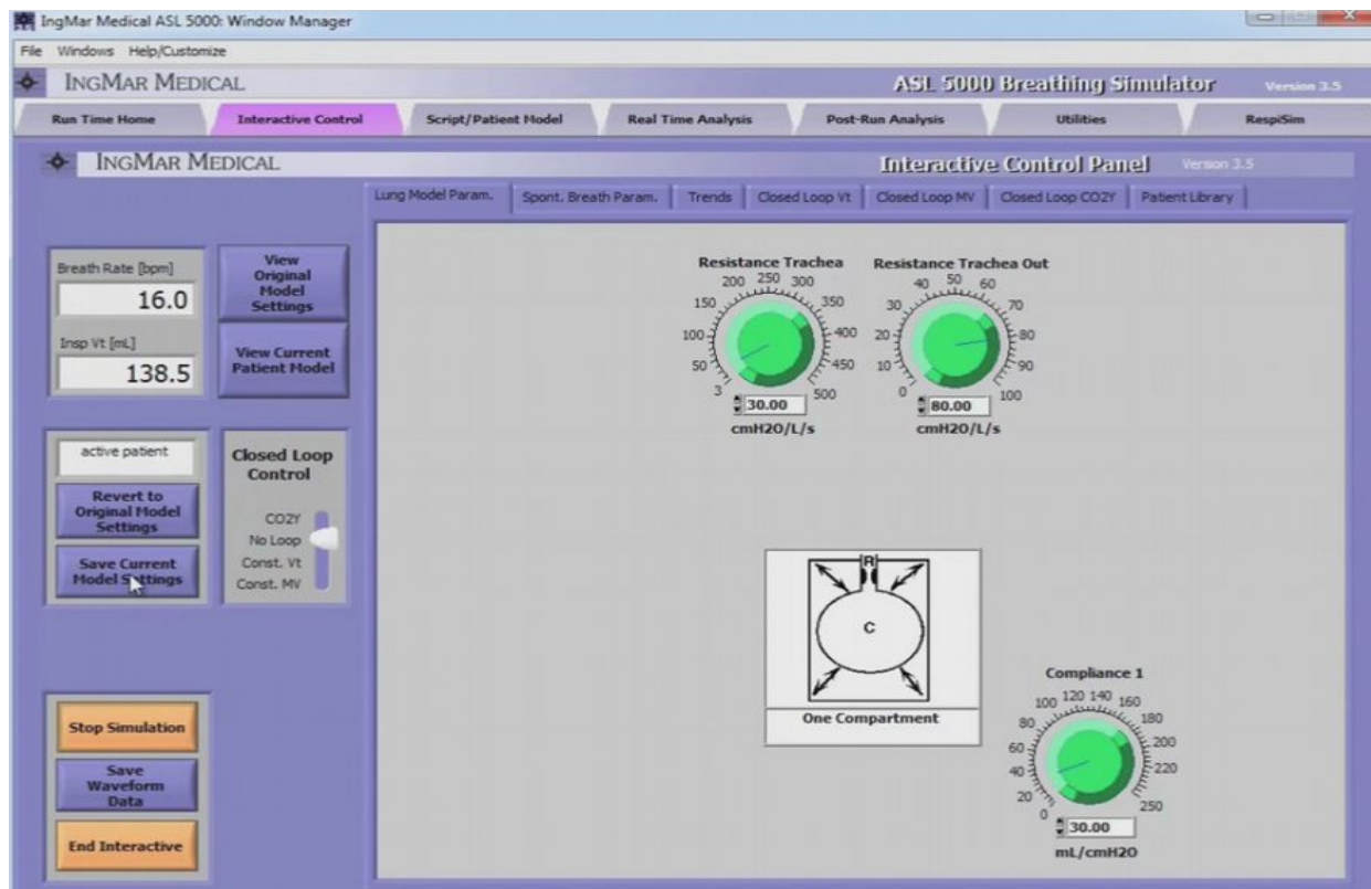
Figura 10 - Configuración de parámetros del ASL5000
