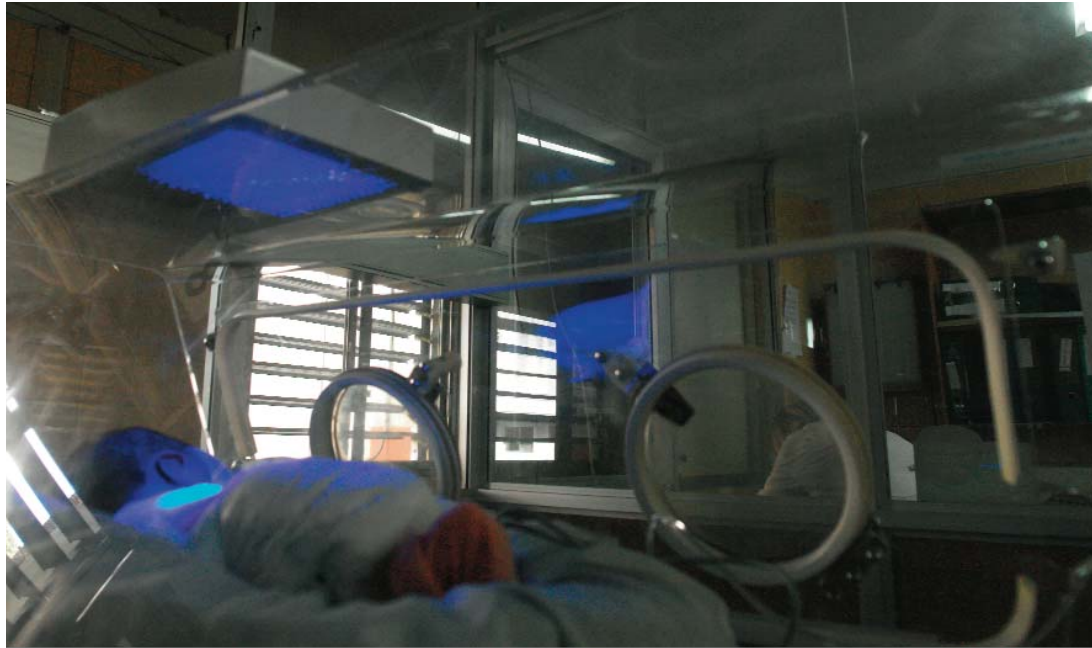
BiliLED emite luz fría por lo que puede apoyarse directamente sobre el acrílico de la incubadora.
