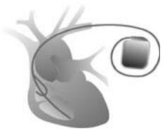
**Figura 4.12 – Cardiodesfibrilador Implantable.** A través del electrodo auricular es capaz de sensar y estimular la aurícula. A través del electrodo ventricular es capaz de sensar y estimular el ventrículo, de hacer estimulación antitaquicardia para interrumpir una arritmia o de liberar entre 1 o 2 bobinas y la carcaza del generador un choque eléctrico de baja intensidad (cardioversión) o alta intensidad (desfibrilación) para interrumpir una arritmia grave.
