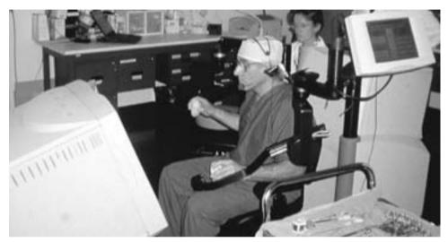
**Figura 7.2** − **El cirujano sentado en la consola del sistema robótico ZEUS™.** El cirujano usa el micrófono para comandar la cámara sensible a la voz y controla los instrumentos con las manos. En primer plano el instrumental quirúrgico que usa el asistente de cirujano que ha colocado previamente los brazos robótico en posición. La visión del cirujano es bi-dimensional.
