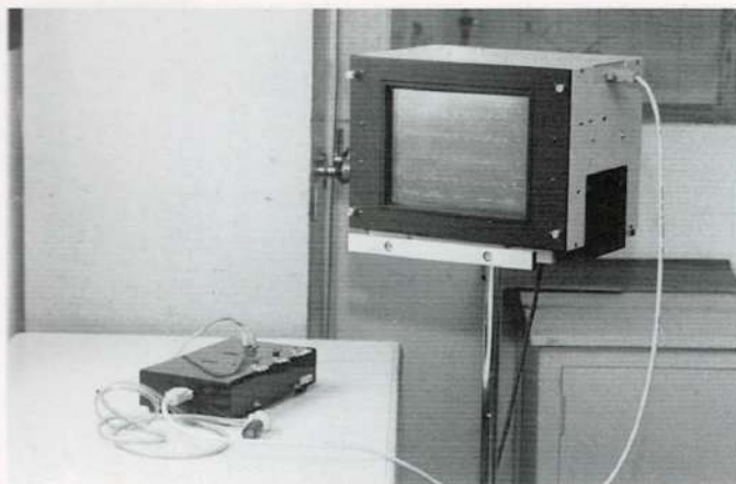
MONRES Monitor sensible al tacto para la presentación de señales respiratorias de un paciente en terapia intensiva. Se estima el trabajo respiratorio, además de desplegar señales de flujo y presiones respiratorias.
