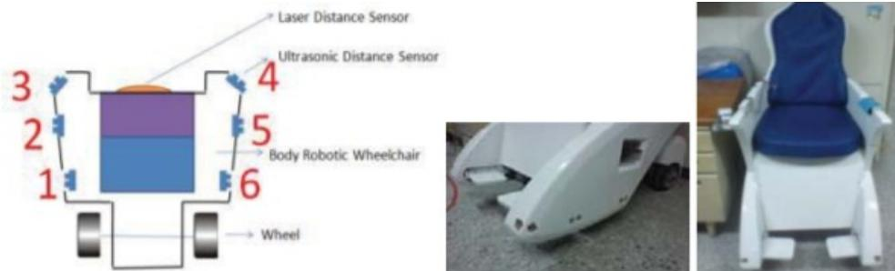
Figura 2. Detalle físico de silla. A la izquierda se observa la disposición de sensores y al medio se muestra la ubicación final en la silla. Extraída de [8].
