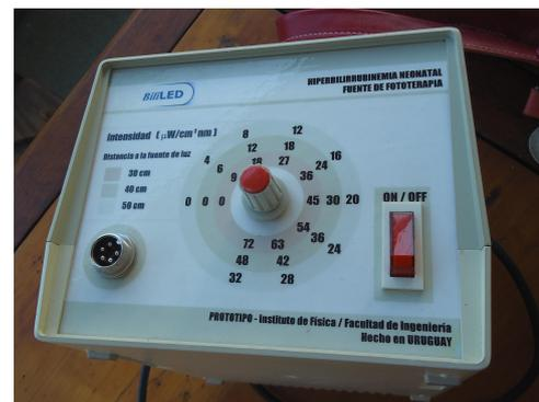
Figura 1. Vista de la cara de control del BiliLED
