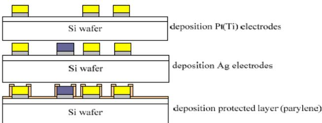
Figura 5 – Proceso de Fabricación de la micro aguja
