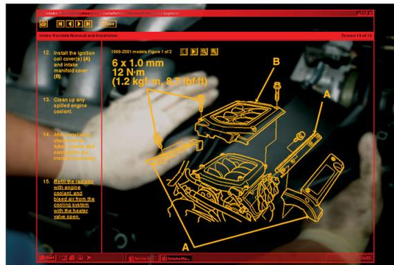
Figura 8: Visión del usuario, en este caso un mecánico, utilizando el dispositivo en modo "see-through".
