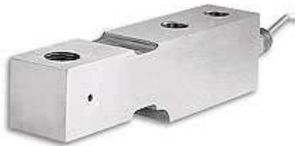
**Figura 5. Celda de carga de flexión de viga. Tiene 2 puntos para la fijación a la carga y mide la flexión a la que se somete en el otro extremo. [8]**
