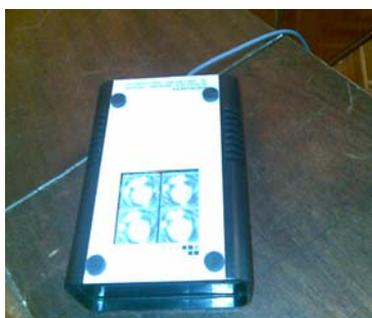
Figura 5 – 2da versión de BiliLED, cara inferior con 4 LED's de potencia
