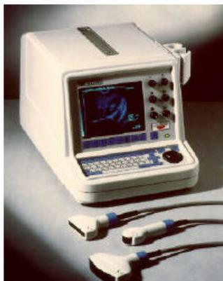
Figura 1 Ecógrafo sencillo con 3 tipos de transductores. Foto cortesía de Dynamic Imaging Limited. Fuente: [2]
