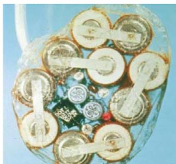
Figura 1. Marcapasos de 1961 conteniendo 2 transistores y 10 baterías de mercurio-cinc. (Tomado de [4]).
