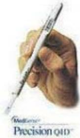
Fig. 7. Dispositivo para medir la concentración de glucosa en sangre (Precision Q4D; <http://www.medicalhomeproducts.com/products/homeglucosetestmeters.htm>).
