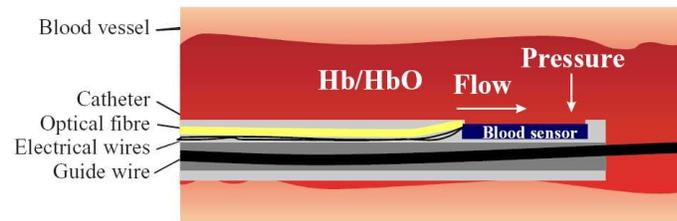
Fig. 10. Sensor integrado
