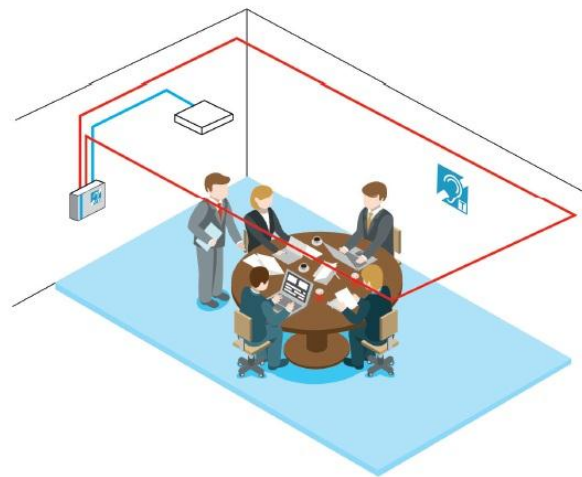
Figura 3 Esquema de instalación de un sistema de aro magnético en una sala de reunión. El trazo rojo es el aro magnético y el azul es la conexión de la señal de audio.
