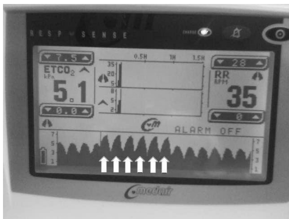
Fig. 6: Registro capnográfico, hay diferencia de amplitud entre los 6 ciclos (flechas blancas-módulo apagado) y restantes (módulo encendido).
